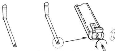
③ 下部金具を 2 セット組立てます。(鋭利部がありますので注意) 下部ブラケットにスライド止め金具を差し込み、下からスライド金具用ネジを軽くねじ込んでください。
