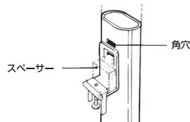
⑤ 脚の上にボード (おもて面を上向き) をのせ、枠の溝に②で緩めた上部金具のツメ部を差し込み、ネジを締め付けてください。(ボードの種類により締め付け位置が異なります。)
