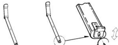
② 脚 2 本を床に置き、手前の上部金具を止めているプラスネジを緩め、上部金具をスライド可能な状態にします。
