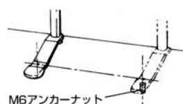
(ハ) 脚プレートの穴にM6ネジ及び平ワッシャーで、しっかりと締め付け、固定してください。
